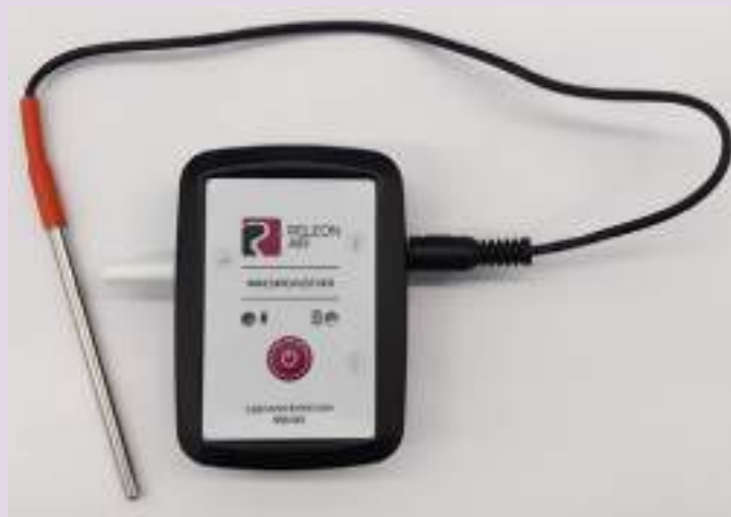
Рис. 12. Датчик температуры тела
