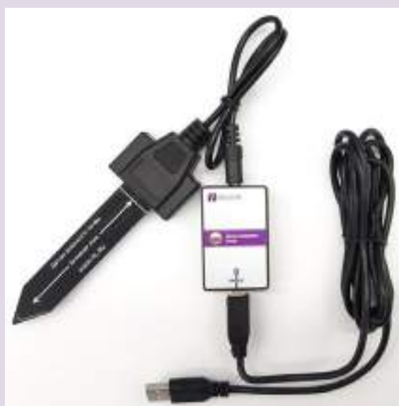
Рис. 4. Датчик влажности почвы
